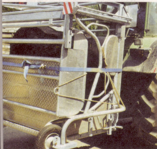
Schlachtbox der Gebr. Hornickel, Variante – fahrbar, mittels Traktor
