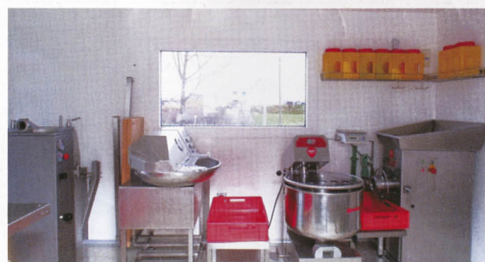
Füller, Kutter, Mischer und Wolf komplettieren die Innenausstattung der fahrbaren Metzgerei.
