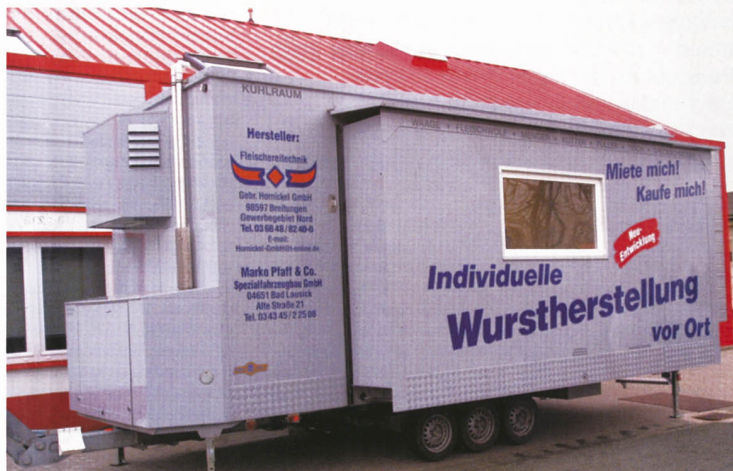
Der Prototyp der fahrenden Metzgerei ist noch mit drei Achsen ausgestattet, das Serienmodell wird dann ein Zweiachs-Tandemanhänger sein.
